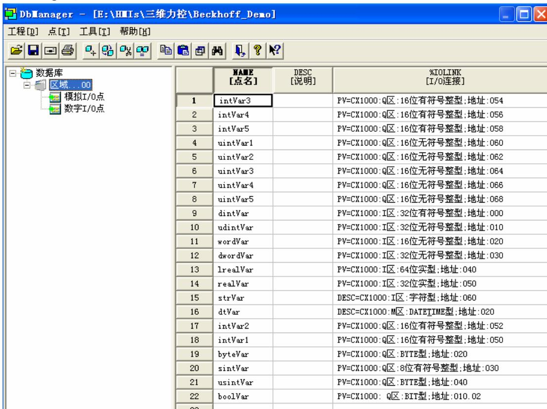
说明：字符型变量strVar和时间型变量dtVar的参数选择DESC，分别用于读写CX1000 PLC程序中的变量stringVar和dtVar。
