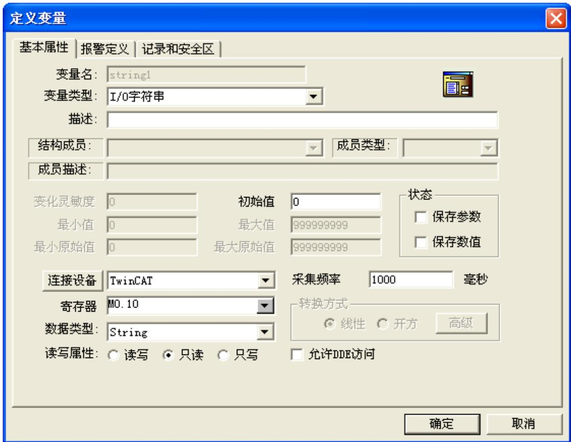
数据词典中添加一个 I/O 字符串类型的变量，连接设备选择之前定义的设备名称，寄存器项填写对应字符串变量的 I/O 地址，地址格式为 I(Q、M)后直接跟一个数值（地址值）再跟小数点+数值（字符串长度）。如上图中的定义对应 PLC 中变量为如下
