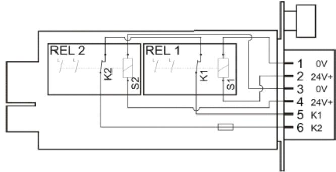
双通道监控功能由经过认证的继电器 (Rel1 和 Rel2) 实现。继电器配有包括反馈触点 (K1 和 K2) 在内的各种强制驱动式触点。反馈触点串联连接, 与 6 针连接器的接口端子 (5) 和 (6) 之间无电势。
