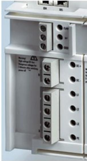
若要安装电源模块，必须移除连接器 X01、X02 与 X03，并用电源模块取代。
