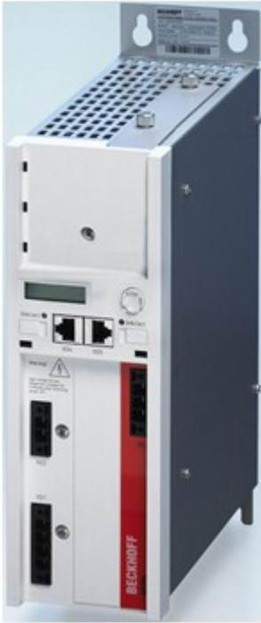
制动模块由内部制动电阻 ( $P_{\text{rms}} = 250 \text{ W}$ ) 与主动散热装置构成。该系统集成了一个用于连接外部制动电阻 (电容高达  $P_{\text{rms}} = 6 \text{ kW}$ ) 的制动斩波器。与 AX5000 系列伺服驱动器的连接是通过 AX bridge 连接模块建立的。
