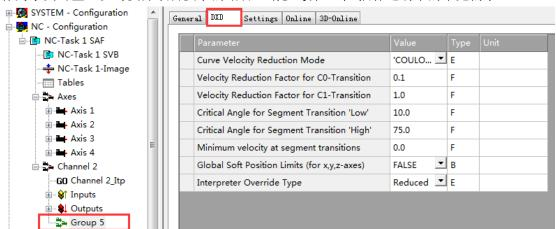
在相邻曲线平滑过渡时的减速模式,由 Curve Velocity Reduction Mode 控制。插补轴的 PTP 软限位设置是否生效,由 Globale Soft Position Limits 控制。
