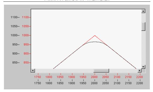
注意: G 代码文件中设置的误差半径持续有效,直到下一句设置该半径的代码执行,或者 TwinCAT 重启。
