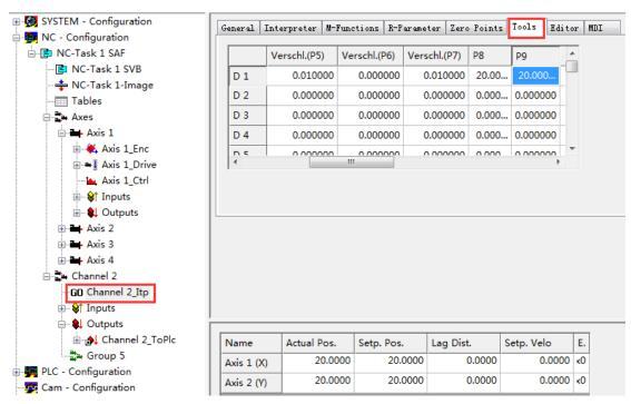
最多可以有 255 套刀具补偿参数,用 D1 到 D255 来区分。每套参数包括 P0 到 P15,但目前只用到 P0 到 P10,说明如下:
