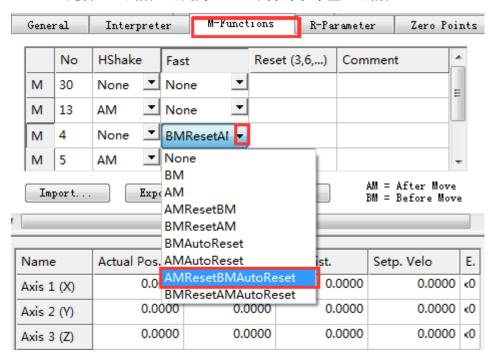
在下拉菜单中的其它选项定义了 M 函数的触发类型和复位方式。
