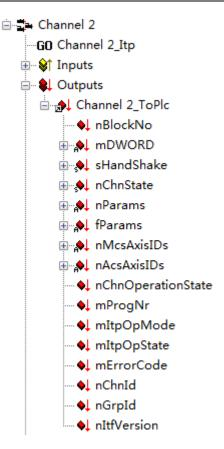
二者不一致,导致在 System Manager 中看到的状态信息,在 PLC 程序中无法一一对应, 所以根据 System Manager 中的变量顺序,新建了结构体 NciChannel\_ToPlc:
