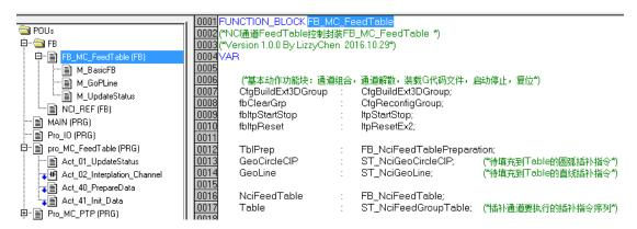
如果当前封装的功能不能满足需求,用户可以在此基础上修改。如果涉及到接口变量的增加,就需要同时修改结构体 FeedTable\_Chn\_Interface,并在 FB\_MC\_FeedTable 增加这些变量的控制代码。
