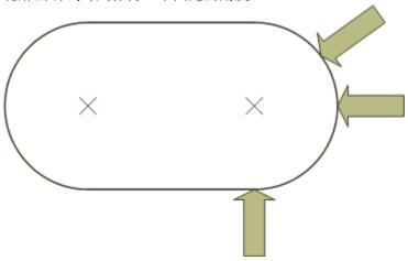
在上图的直线段刀具的方向不变。相比之下,相对于基准坐标系的方向必须在圆周内连续变化。假设直线和圆弧过渡点的轨迹速度不为 0,旋转轴就不可避免会产品一个速度跃变,而轨迹插补轴不会跃变。
