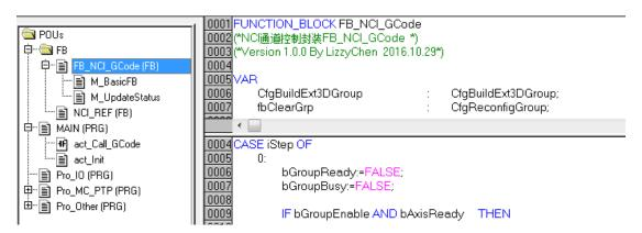
如果当前封装的功能不能满足需求,用户可以在此基础上修改。如果涉及到接口变量的增加,就需要同时修改结构体 GCode\_Chn\_Interface,并在 FB\_NCI\_GCode 增加这些变量的控制代码。
