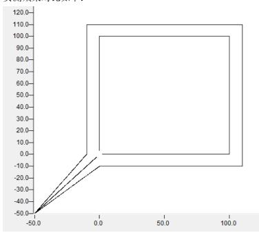
上图中,外圈为启用刀具补偿的 X、Y 轴轨迹。内圈为禁用刀具补偿的 X、Y 轴轨迹。
