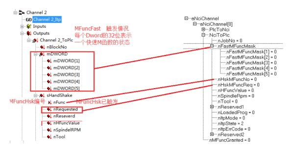
快速 M 函数的状态用 5 个 DWord 来表示,每个 DWord 的 32Bit 表示 32 个 M 函数的状态,总共可以表达 160 个 M 函数。由 M 函数的最小编号是 M1,所以实际上第 1 个 DWord 的 Bit0 不对应任何 M 函数,所以 M 函数的最大值不超过 159。
