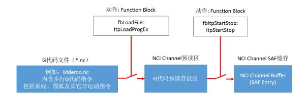
而使用 FeedTable 的时候,不是用 G 代码解释器,而是从 PLC 程序通过功能块 FB\_NciFeedTable 往 NCI 的执行区(SAF Entry)里填充指令。对于熟悉 PTP 中的 TwinCAT NC Fifo 的用户,这点比较容易理解。
