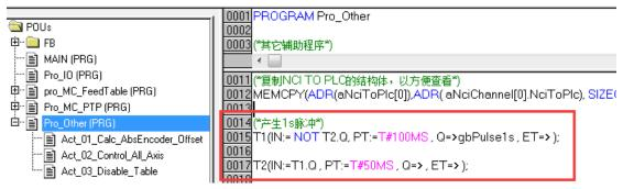
前面提到,这个信号在 FB\_MC\_FeedTable 中用于触发 ADSRead,读取 NCI 通道的 Buffer 指令数量。当然实际项目中,这个信号还可以用于闪灯等其它公共用途。
