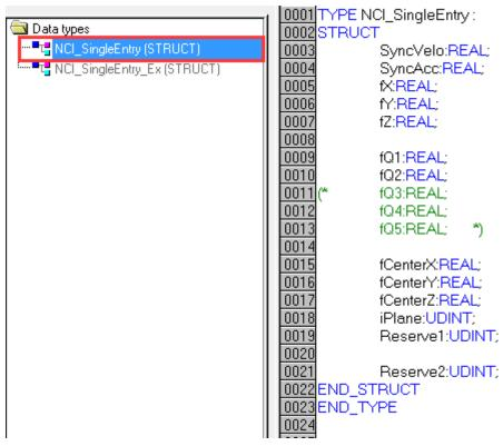
圆弧还是直线插补,用 iPlane 来区分。如果该变量为 0,表示直线插补,否则为圆弧插补。这个逻辑在 4.1.3 编写基本代码的第 2 项"准备待填充到 Table 的插补指令的数据"的 M GoPLine 子程序中实现。
