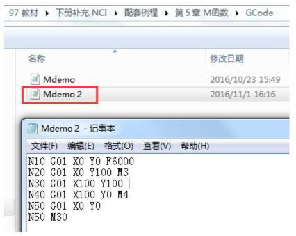
G代码文件 MDemo2.nc 应复制到控制器的"C:\TwinCAT\CNC\"路径下。
