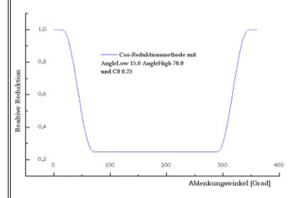
与库仑曲线相反,库仑减速是先快再慢再快,余弦减速是先慢后快再慢,并且 余弦减速有底线的,减到最小值 Vk\*C0 factor 就不再减了。 而库仑减速可以减 到0速。
