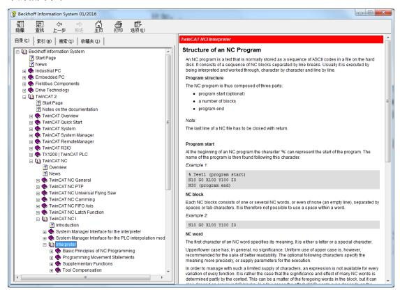
一个实际项目上用的 G 代码文件包括多种指令,其中最核心的当然是以"G"字母打头的控制动作的指令,比如常用的: G01(直线插补), G02/G03(圆弧插补)。执行动作的 G代码同行通常会指定进给速度,即 F 指令。比如:
