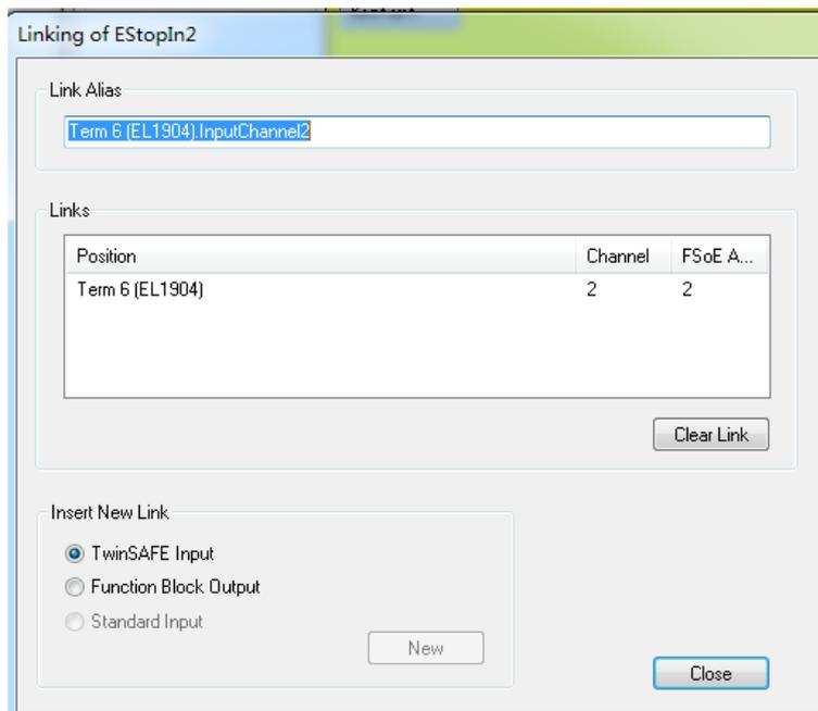
9. 点击急停功能块的输出侧，在 Insert New Link 中选择 TwinSAFE Output，点击 New
