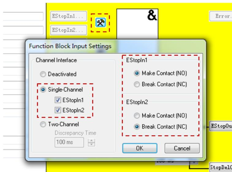
此处，由于实验设备上，EL1904 的输入 1 通道接入了急停开关的 NO 点，输入 2 通道接入了急停开关的 NC 点，所以将 Estop 功能块的输入依次设置为 NO，NC
