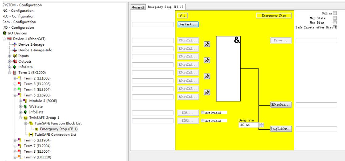
4. 点击输入侧设置图标，选择启用的通道和对应的 NC/NO 状态
