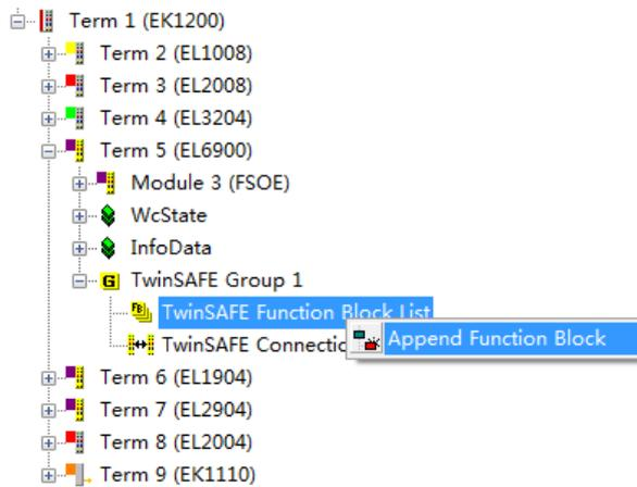
目前基于 TwinCAT 2 的 TwinSAFE 系统共提供以下多种符合安全认证要求的安全功能块，供工程师使用
