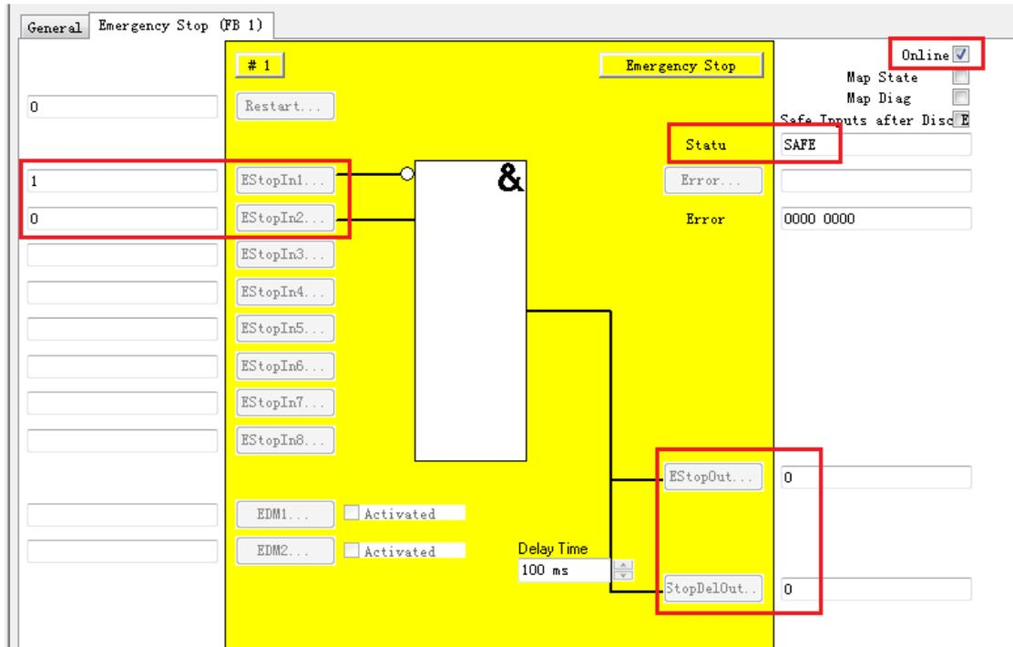
7. 如果需要再次有输出，需要在外部急停开关复位后，将该急停功能块进行手动复位，即 Restart 先置为 1，再复位
