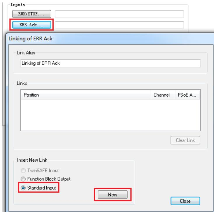
选择 PLC 程序中的 xErrAck 进行绑定
