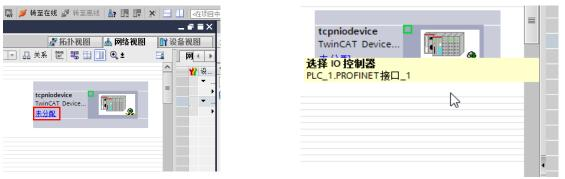
点击刚才拖动的硬件上的"未分配"按钮,为 IO 选择对应的控制器,点击连接 S7-1200 的网络名称,本例是"PLC\_1.PROFINET 接口\_1"。
