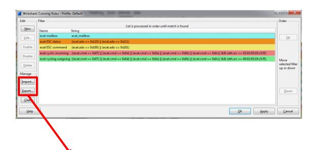
一旦定义了颜色标记规则,此后这台PC上所有的Wireshark追踪都会应用这套规则。通过导出和导入功能,一台机的颜色标记规则还可以移植到另一台PC上。
