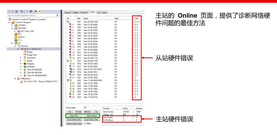
系统上电时候可能产生硬件错误,并在TwinCAT中累加,而通常这些错误并不代表有问题。所以,查找可能的硬件问题时,建议清除程序启后的所有错误计数,这样才能监视到运行过程中发生的实际错误次数。
