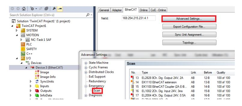
Emergency Scan 能够快速检查EtherCAT网络的永久硬件问题 (设备、电缆或者接头损坏).
