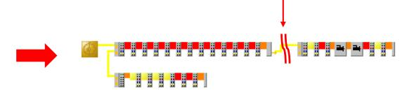
连接永久中断的原因,可能是接头被拔出,电缆严重损坏,或者设备掉电。
