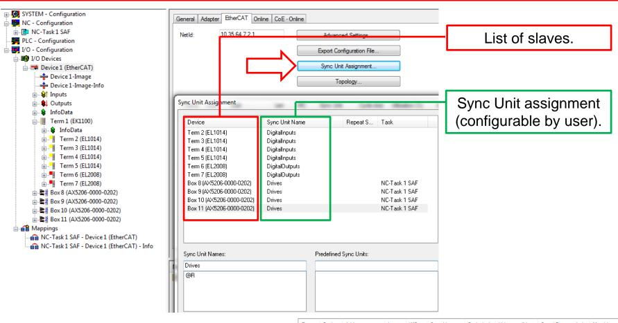
TwinCAT为不同的Sync Units(同步单元)创建独立的数据报文,每个报文拥有自己 Working Counter 计数器
