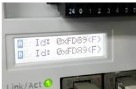
图 4.2 在伺服驱动器 LED 屏上读取伺服故障信息
