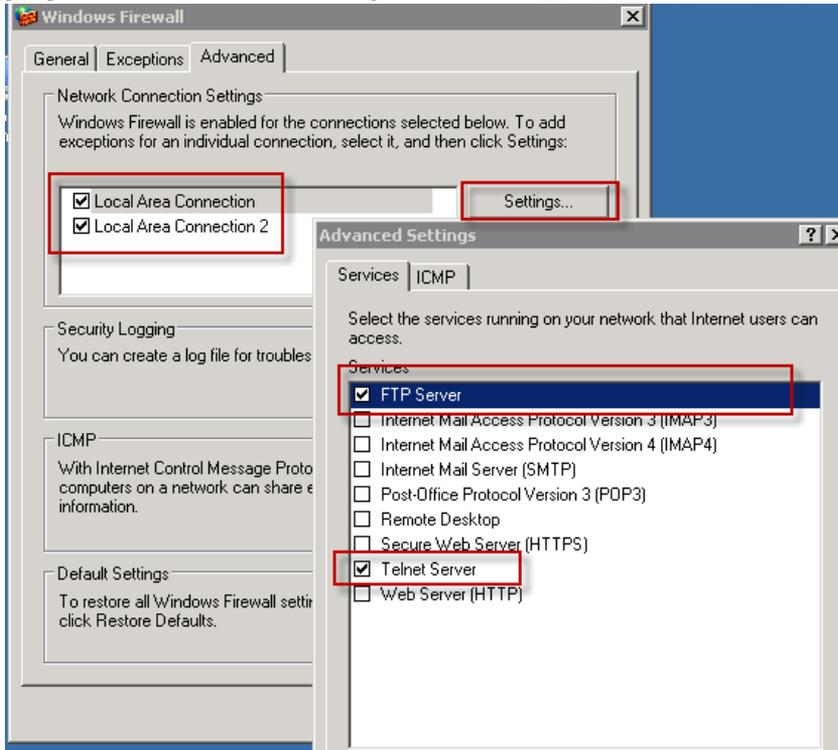
7. 测试ftp功能, 如果FTP可以访问。按第四步操作, 将防火墙开启。
