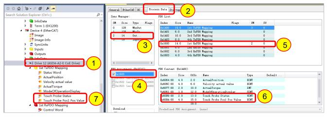
3) 配置驱动的 Latch 控制字,不同驱动器品牌,latch 的方式有差异,CANopen 并未定义 latch 功能;台达驱动器的 Latch 控制字对应于 Touch probe Function PDO(60B8h);
