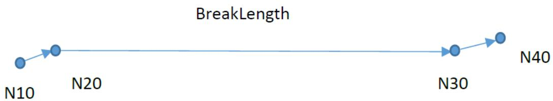
**LineMergeDiff:** 如果变化 (垂直距离) 小于 LineMergeDiff 相邻控制点将被合并。例中 N30 可被删掉以简化控制多边形。
