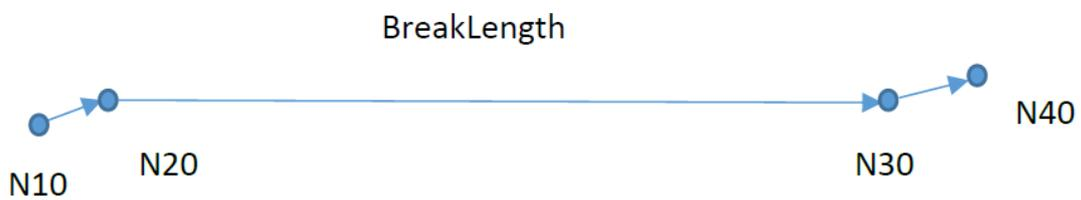
**MergeDiff:** BSpline 由贝塞尔段构成。为了提高处理速度，样条曲线可以通过合并来压缩。当控制点间的差距小于 MergeDiff 时相邻段将被合并在一起。下面的相邻段被合并成一条。
