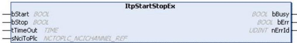
ItpStartStopEx 功能块的 bStart 和 bStop 输入都是上升沿触发，同时 bStop 的优先级高于 bStart，所以如果同时触发信号，bStop 将优先执行。该停止指令将删除 NCI 通道中的数据，不支持从停止前的状态的启动。程序如下
