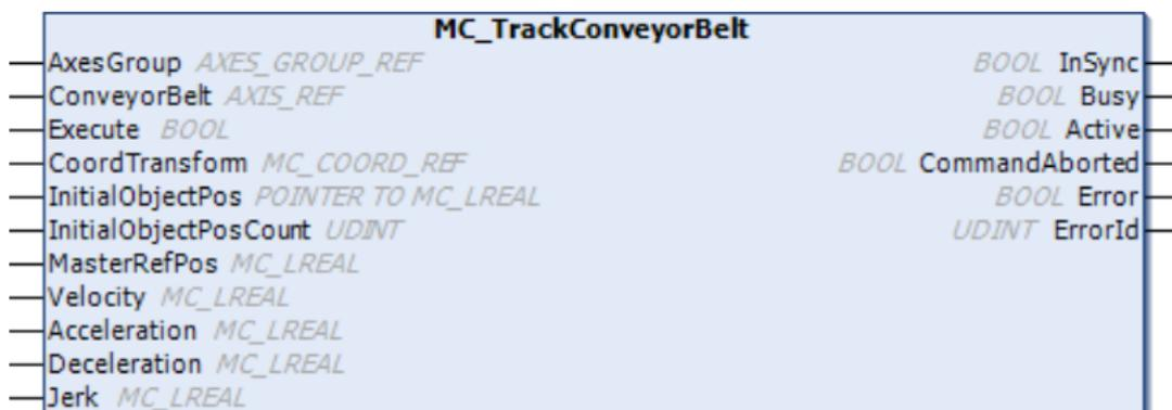
TwinCAT 的 PickAndPlace 功能可以直接通过 MC\_TrackConveyorBelt 功能块实现与视觉的配合完成传动带上的抓放功能。与 FlyingSaw 相比不需要使用额外的虚拟轴，更加方便。该功能块仍然需要与 MC\_MovePath 配合使用。当 InSync 信号与 MC\_MovePath 的 Done 都出来时，完成追踪抓取。
