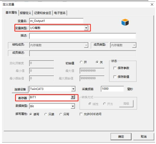
图中,变量名一栏经测试可以不用和 TwinCAT3 中定义的变量名一致,这里设置为一样只是为了方便识别。寄存器列一栏,非常容易填错,客户必须按照图中格式书写。BIT1 表示的含义为 bit 类型数据通道为 1。同时需要修改 C:\Program Files (x86)\Kingview\Driver 路径下的 Var.csv 文件,如下图:
