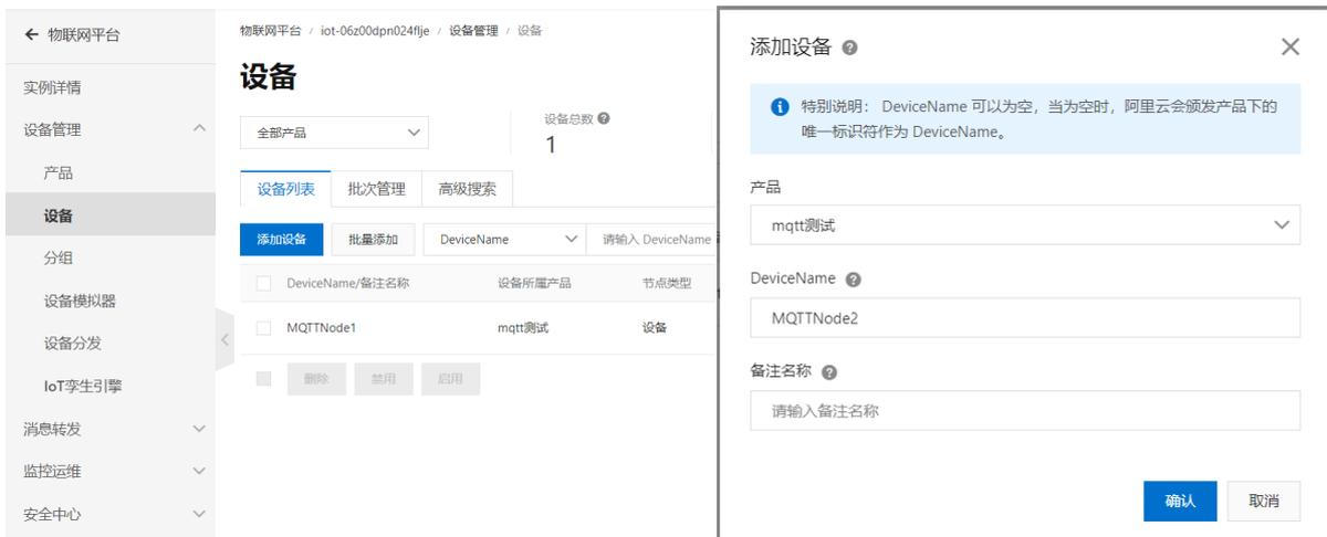
进入新建节点内部，可以看到节点的设备信息，点击查看 MQTT 连接参数，包括设备 ID、用户名、连接密码、MQTT 主机连接和端口号。这些参数后续在 PLC 程序里也会涉及。
