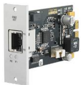
C9900-E270 USB extender Tx 模块
